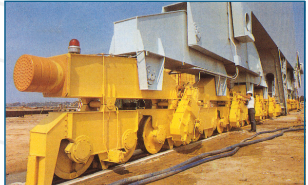
Zellstoffpuffer am Fahrwerk eines 900t Bockkranes
