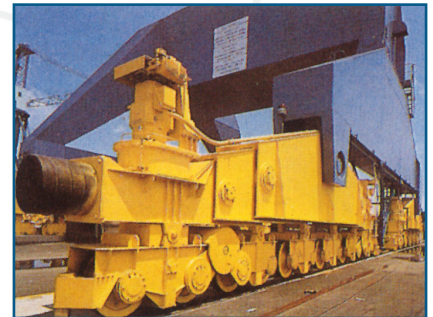
Zellstoffpuffer am Fahrwerk eines 200t Werftkranes
